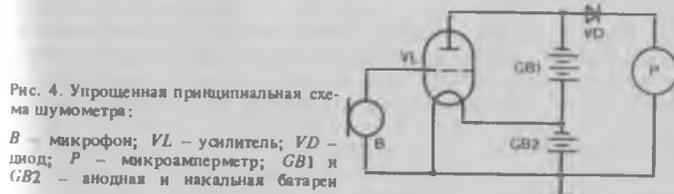
Рис. 4. Упрощенная принципиальная схема шумомера:
