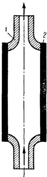
Рис. 124. Электропастеризатор прямого действия промышленной частоты:
