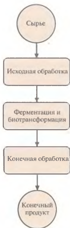
Рис. 1.1. Основные этапы биотехнологического процесса. Термин был введен Карлом Эреки и относился к крупномасштабному получению свинины (конечный продукт) с использованием дешевой сахарной свеклы (сырье) в качестве корма для свиней (биотрансформация).
