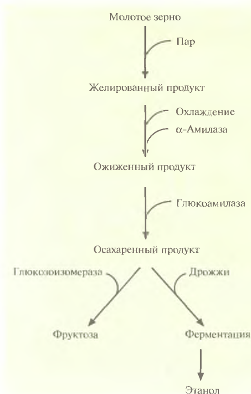
Рис. 13.10. Промышленное производство фруктозы и этанола из крахмала.
