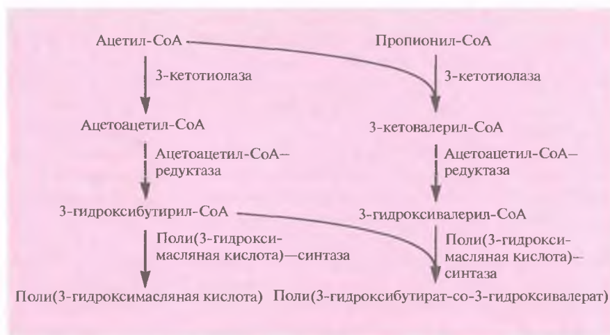
Рис. 12.23. Микробиологический синтез поли(3-гидроксибутирата-со-3-гидроксивалерата).
