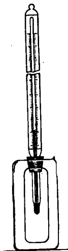
Рис. 7. Прибор Жукова для определения температуры застывания.
