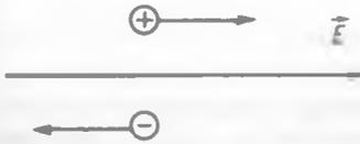
Рис. 2.6. Схема движения зарядов во внешнем электрическом поле напряженностью  $E$
