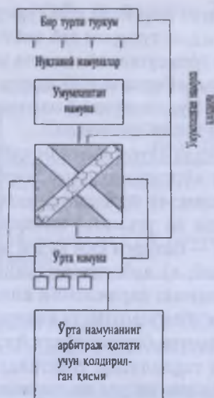
5- расм. Ўрта намуна ва ўлчанмаларни ажратиб олиш схемаси.
