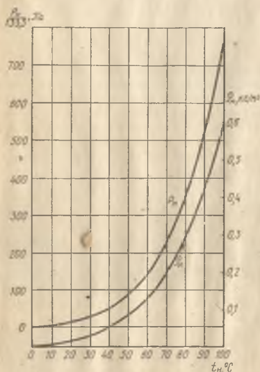
Рис. I-47. Зависимость \rho_n и \rho_{c.в} водяного пара от его температуры.
