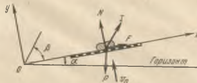
Рис. III—27. Расчетная схема виброслоя с конвективным подводом тепла.
