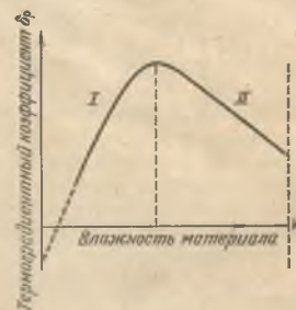
Рис. 11—12а. Зависимость термоградиентного коэффициента от влажности материала.
