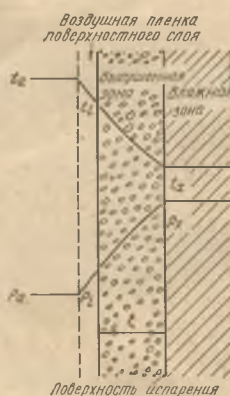
Рис. II—27. Схематическая модель распределения температуры слоя и парциального давления пара во второй период сушки.
