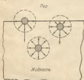
Рис. 1—5. Упрощенная схема взаимодействия двух фаз (жидкость — пар) на границе раздела.
