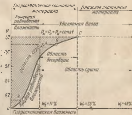
Рис. 1—61. Схема классификации влаги в материале в увязке с процессом ее удаления при сушке
