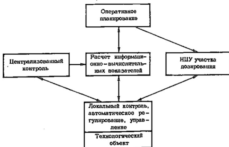
Рис. 1.2. Иерархическая структурная схема АСУ ТП производства маргарина
