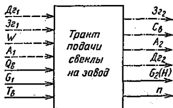
Рис. 1.5. Параметрическая схема тракта подачи свеклы на завод (пунктиром и штрихпунктиром показаны соответственно входные и выходные неизмеряемые параметры, сплошными линиями — соответственно измеряемые параметры)
