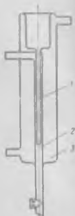
Рис. 26. Схема установки В. А. Милчева для определения теплопроводности:
