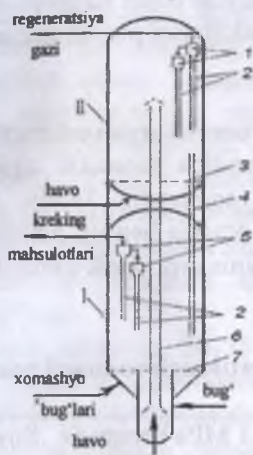
5-rasm. Flyuid-kreking jarayoni reaksiya tarmog'i sxemasi: 1-reaktor; II-regenerator; 1,5-siklonlar; 2-katalizator trubalari; 3,7-taqsimlash panjaralari; 4-oqim trubasi; 6-ko'taruvchi moslama.
