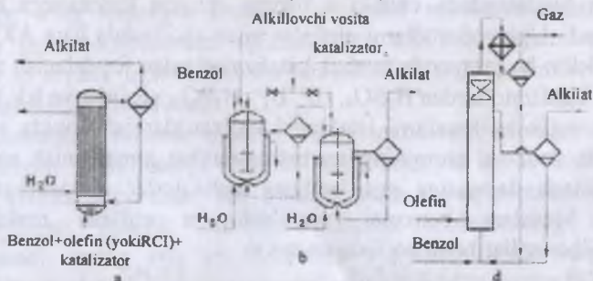
37-rasm. Alyuminiy xlorid ishtirokida aromatik uglevodorodlarni alkillash reaksiya reaktorlari: a) trubkasimon reaktor; b) aralashtirgichli reaktorlar; d) kolonna ko'rinishdagi reaktorlar.
