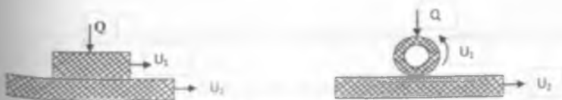
5.9 - rasm. Namuna yuzasining eyilishi sxemasi:
