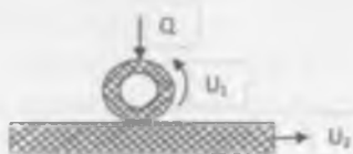
5.9 - rasm. Namuna yuzasining eyilishi sxemasi:
