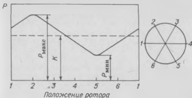
Рис. 4.20. Диаграмма для определения места и величины разбаланса.
