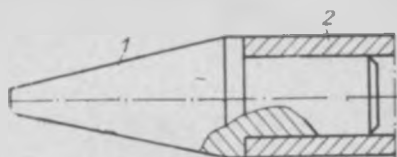
Рис. 4.15. Направляющий конус: 1 — оправка; 2 — труба.
