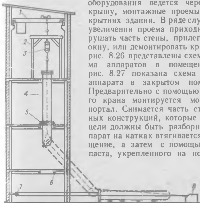
Рис. 8.27. Монтаж аппарата в здании цеха:
