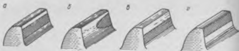
Рис. 4.13. Проверка на краску зацепления зубчатых колес:
