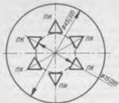
Рис. 4.9. Размещение пироскопов на огнеупорной подставке
