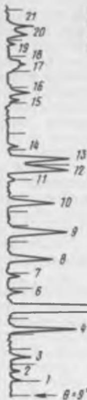
Рис. 1.7. Рентгенограмма цементной сырьевой смеси (цифры соответствуют номерам линий в табл. 1.2, вертикальные линии — реперные отметки)
