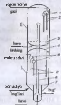
5-rasm. Flyuid-kreking jarayoni reaksiya tarmog'i sxemasi:
