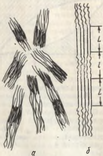
1.9- расм. Кристалл полимернинг схематик тасвири: а—реал полимер; б—эквивалент модел.
