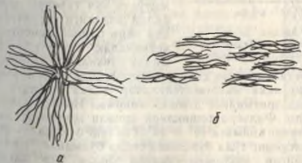
1.11- расм. Полимер структура уюшмаларининг кейинги мураккабла- шишларида ҳосил қилган структураларнинг схематик тасвири:
