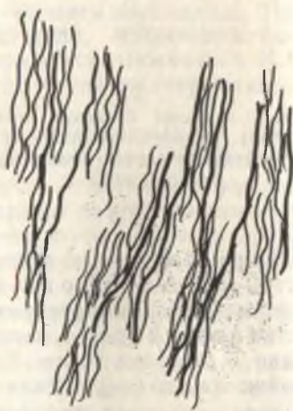
1.10- расм. Пачкалар орқали ўтадиган макромолекула занжирларининг схематик тасвири.
