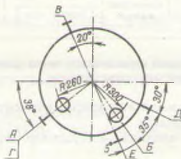
5.2 - расм. Люк, бобишка ва штуцерларнинг жойлаштириш схемаси.
