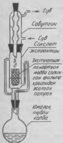
7- расм. Сокалет экстрактори қаттиқ моддани эритувчи билан ёрдамида моддаларни ажратиш асбоби
