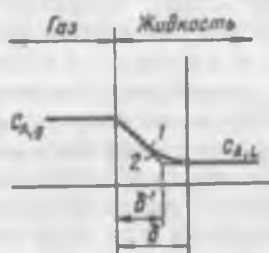
Рис. 9.12. Аппроксимация нелинейного концентрационного профиля при наличии химической реакции:
