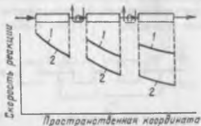
Рис. 13.12. Изменение скорости химического превращения в каскаде реакторов вытеснения:
