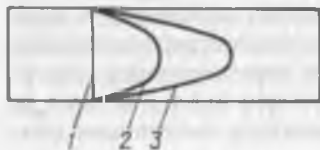
Рис. 6.3. Размывание «поршневого» потока при ламинарном течении (тейлоровская диффузия, вызванная неравномерностью поля скоростей):
