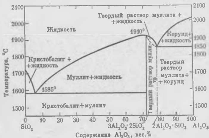
Рис. 43. Диаграмма состояния системы \text{Al}_2\text{O}_3\text{--SiO}_2
