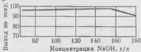
Рис. 55. Зависимость выхода по току от концентрации щелочи в катодите
