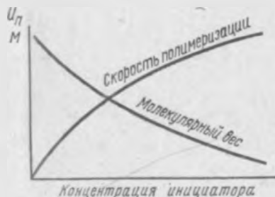
Рис. 94. Зависимость скорости полимеризации и молекулярной массы полимера от концентрации инициатора
