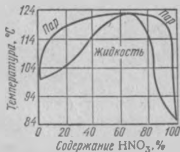
Рис. 26. Диаграмма кипения водных растворов азотной кислоты под атмосферным давлением
