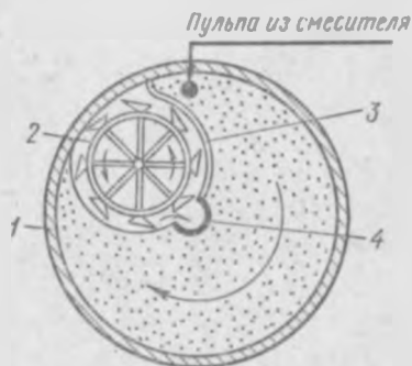
Рис. 31. Схема суперфосфатной камеры непрерывного действия (план):
