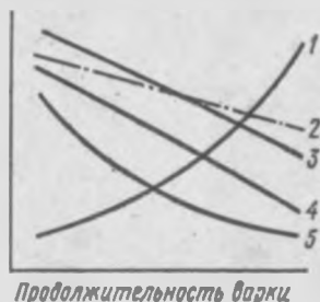
Рис. 100. Изменение состава древесины и степени полимеризации целлюлозы в процессе варки:
