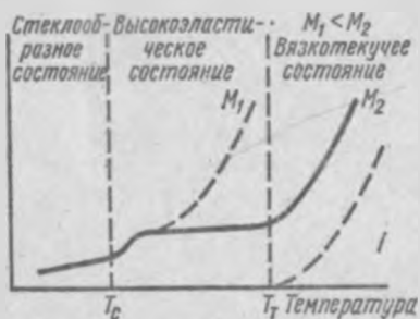
Рис. 91. Зависимость деформации полимера от температуры при постоянной нагрузке
