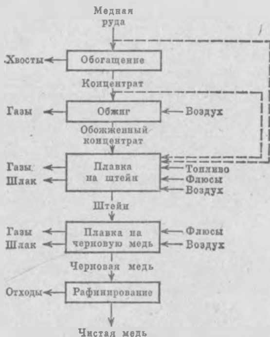
Рис. 54. Схема пирометаллургического способа производства меди
