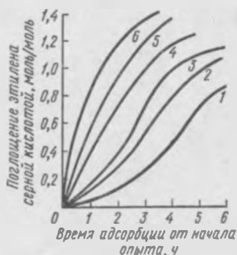
Рис. 76. Влияние давления на степень насыщения серной кислоты этиленом:
