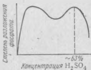
Рис. 29. Зависимость степени разложения фосфата от концентрации исходной серной кислоты
