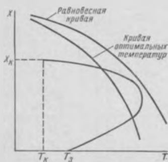
Рис. 111. Кривые изменения выхода продукта экзотермической реакции и температуры для трубчатого контактного аппарата:
