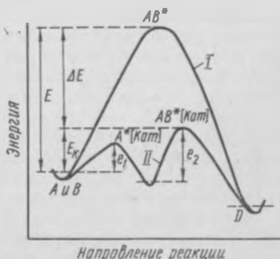
Рис. 95. Изменение энергии реагирующей системы при некаталитической (I) и каталитической (II) реакции
