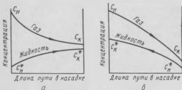
Рис. 11. Изменение концентраций при абсорбции компонента газовой смеси жидкостью в башне с насадкой: а — прямоток; б — противоток
