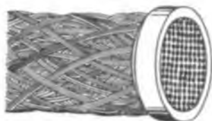
11.29- расм. Фторопластдан қилинган трубади иссиқлик алмашигич элементи.
