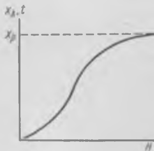
Рис. 35. Изменение степени превращения x_A и температуры по высоте (длине) адиабатического реактора при экзотермической реакции
