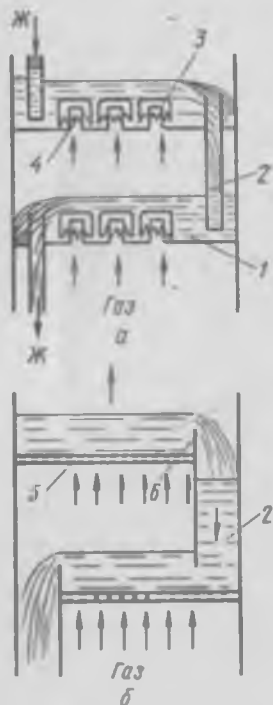
Рис. 77. Схема устройства барботажного реактора с колпачковыми тарелками и внутренними переливами (а) и с ситчатыми тарелками (б):
