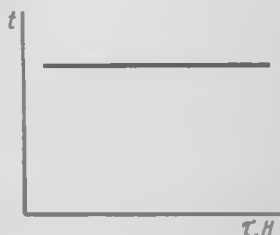
Рис. 36. Температурная характеристика изотермического реактора
