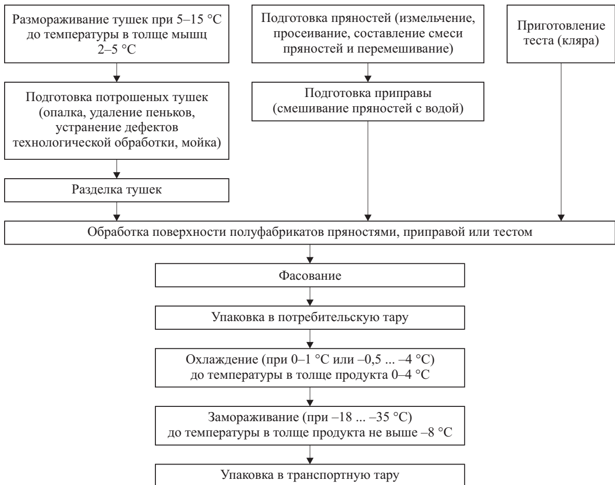
Рис. 2.3. Технологическая схема производства натуральных полуфабрикатов из мяса птицы
