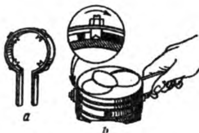
1.7-rasm. Prujinali siqgich yordamida porshen ariqchasidan qurumni tozalash: a —siqish qurilmasi; b —tozalash jarayoni.
