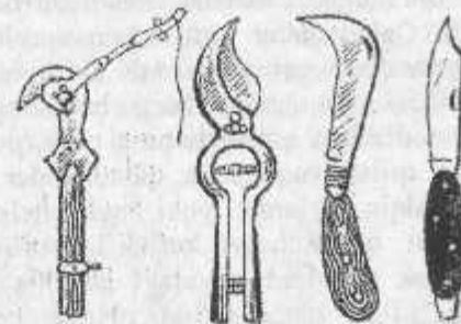
17-rasm. Qalamcha tayyorlash va kurtak payvand qilishda ishlatiladigan asboblari.
