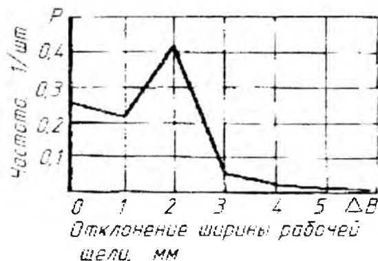
Рис.2.5. Распределение величин отклонений ширины РЩ от установленного значения при повороте барабанов на 90^0
