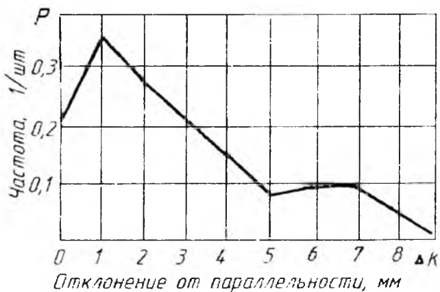
Рис.2.3. Распределение величин не параллельности смежных шпиндельных барабанов
