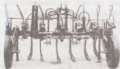
рисунок 12. Плуг чизельный ПЧК-2,5 для обработки почв, засоренных камнями, к трактору тягового класса 3
