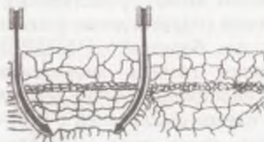
рисунок 25. Рабочий орган (а) рыхлителя "Deltaplow" фирмы "Rau Sicam" и схема рыхления почвы (б) двумя стойками
