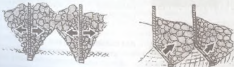
рисунки 22-23. Схема рыхления почвы прямой (а) и наклонной (б) стойками
