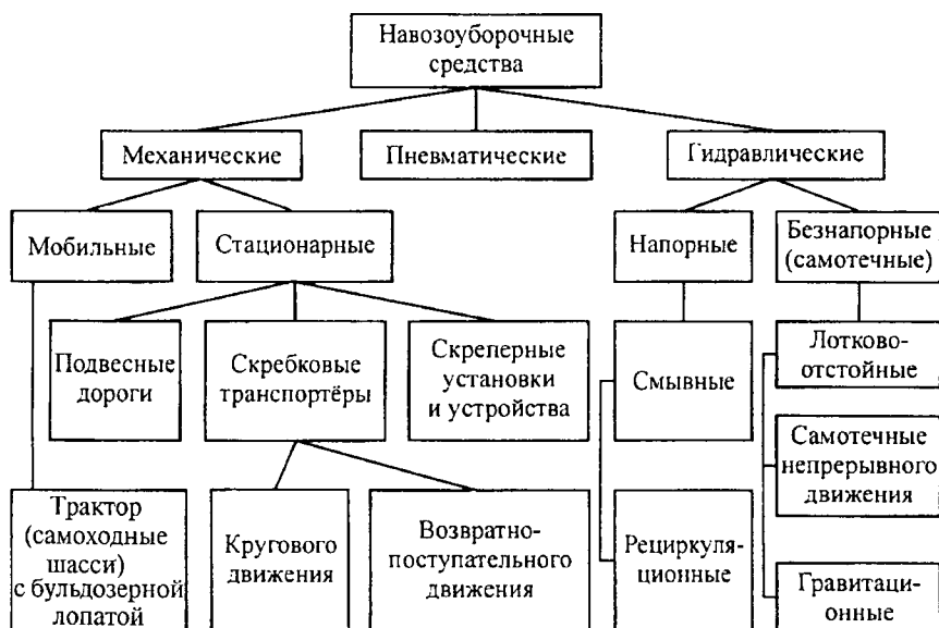
Рис. 25.1. Классификация устройств для удаления навоза из помещений
