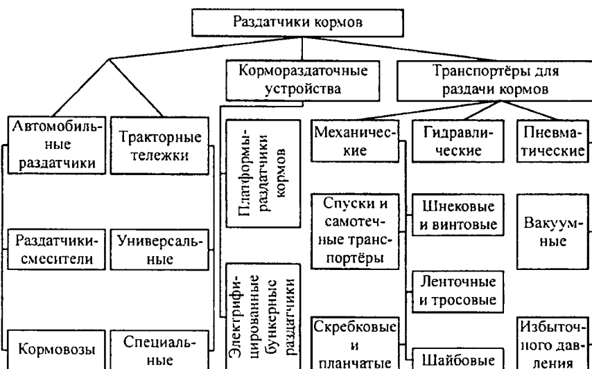
Рис. 23.1. Классификация раздатчиков кормов
