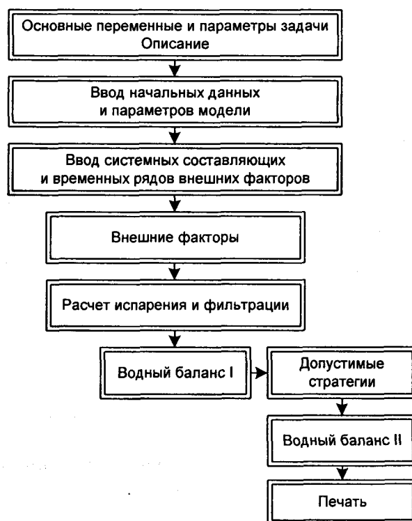
Рис. 12.4. Блок-схема расчета водного баланса на ЭВМ
