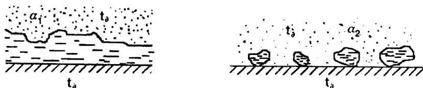
10.3- rasm. Kondensatsiyalanishda issiqlik berilish sxemasi.
