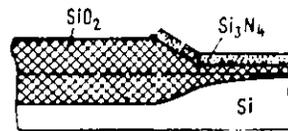
Рис. 8.5. Увеличение размера изолирующей области  $\text{SiO}_2$  из-за боковой диффузии кислорода и повышения коэффициента диффузии в приповерхностной области
