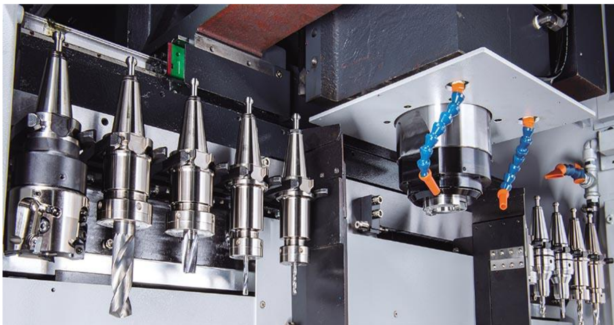
11.6 – rasm. 10 ta o‘tishga mo‘ljallangan asboblar magazini.
