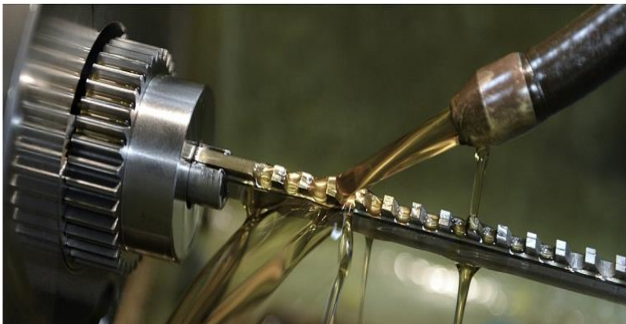
4.17 – rasm. Shesternyaga ichki teshigiga sovituvchi moy yordamida shponka o'yig'ini sidirish jarayoni.
