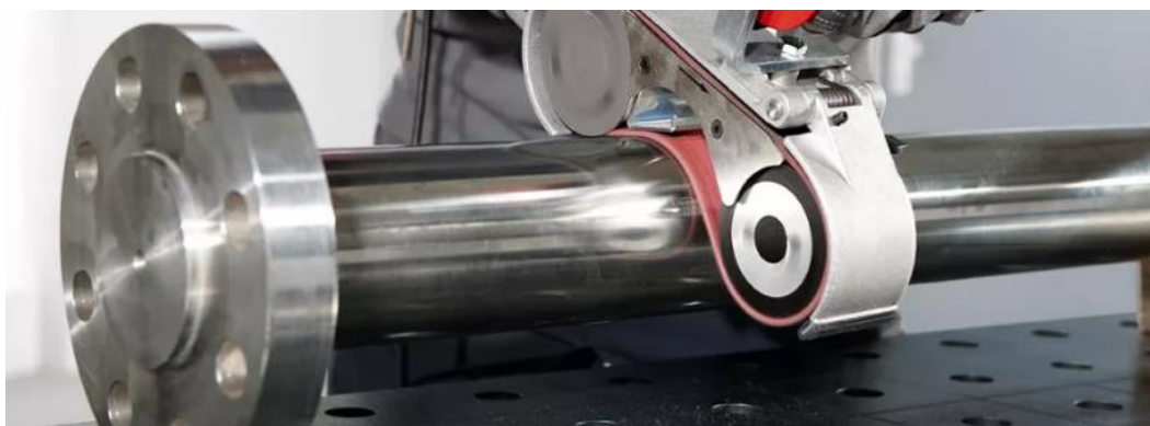
8.20 – rasm. Supperfinishlash jarayonlari. a –porshen detalini yaltiratish; b – val tipidagi detalni jilolash.
