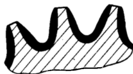
Рис. 154. Конфигурация закаленного слоя (выделен зачернением) на зубьях при закалке «по впадине»
