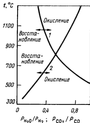
Рис. 6. Кривые равновесия реакций \text{Fe} + \text{CO}_2 \rightleftharpoons \text{FeO} + \text{CO} (1) и \text{Fe} + \text{H}_2\text{O} \rightleftharpoons \text{FeO} + \text{H}_2 (2)
