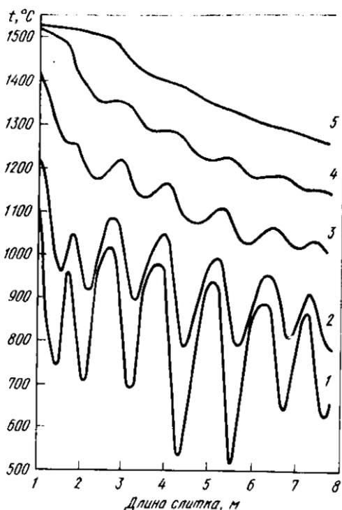
Рис. 42. Изменение температуры на поверхности (1); на глубине 7,5 мм (2); 22,5 мм (3); 37,5 мм (4); 52,5 мм (5) слитка
