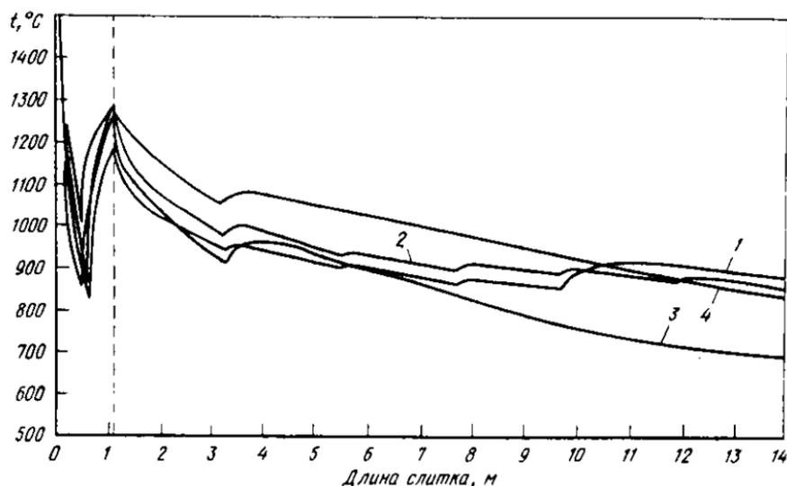
Рис. 39. Изменение температуры поверхности для узкой (1, 2) и широкой (3, 4) граней соответственно при скорости разливки 0,4; 0,7
