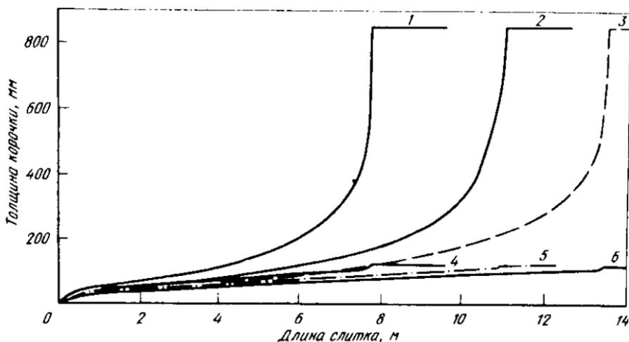
Рис. 37. Изменение толщины корочки для узкой (1, 2, 3) и широкой (4, 5, 6) граней при скорости разливки, м/мин: 0,4; 0,55; 0,7
