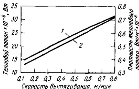
Рис. 14. Зависимость  $Q$  (1) и  $q$  (2) от скорости разливки
