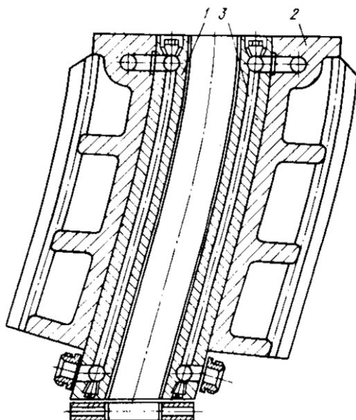
Рис. 4. Кристаллизатор криволинейной МНЛЗ
