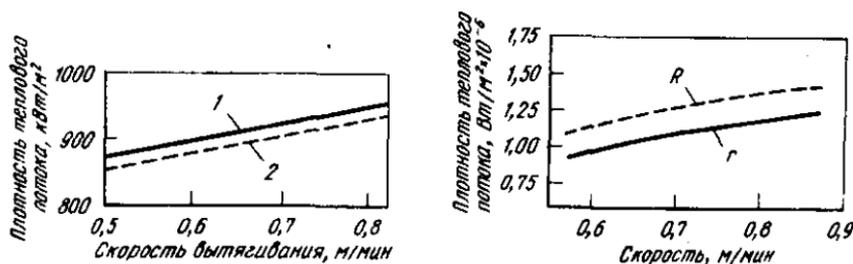
Рис. 15. Зависимость плотности теплового потока от скорости разливки в кристаллизаторе:
