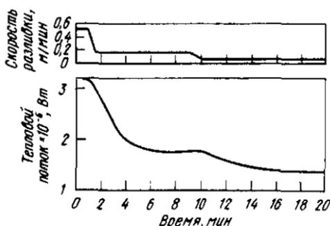
Рис. 12. Переходные процессы в кристаллизаторе
