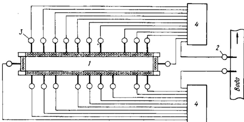
Рис. 7. Схема посекционного калориметрирования кристаллизатора: 1 – кристаллизатор; 2 – измерение температуры воды на входе; 3 – измерение температур на выходе из секции; 4 – вторичные приборы
