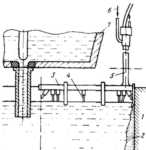
Рис. 27. Схема расположения блока термометров в кристаллизаторе: 1 - стенка кристаллизатора; 2 - корочка слитка; 3 - блок термометров; 4 - термометр в чехле; 5 - штанга; 6 - воздух; 7 - промежуточный ковш
