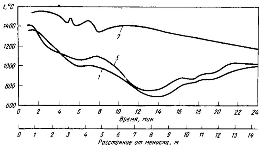
Рис. 30. Изменение температур в сечении криволинейного слитка (цифры у кривых – номера термопар)
