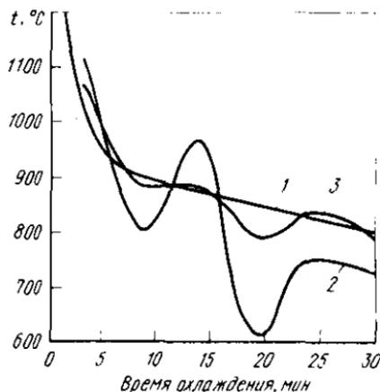
Рис. 22. Изменение температуры оптимальной (1), до отработки режима (2) и после корректировки (3)
