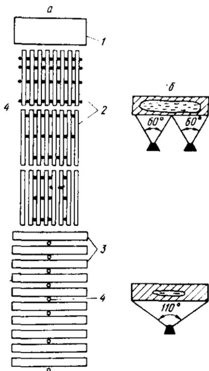
Рис. 17. Схема поддерживающей системы зоны вторичного охлаждения (а) и расположение форсунок по ширине слитка с углами раскрытия  $60^\circ$  и  $110^\circ$  (б):
