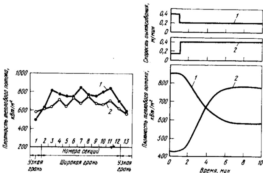
Рис. 8. Распределение плотности теплового потока по граням кристаллизатора при профилированных (1) и гладких (2) стенках
