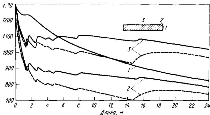
Рис. 44. Изменение температуры поверхности по длине слитка (цифры у кривых – номера точек)
