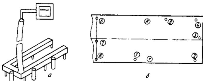
Рис. 29. Схема блока (а) и расположение термопар в сечении (б) для криволинейной МНЛЗ
