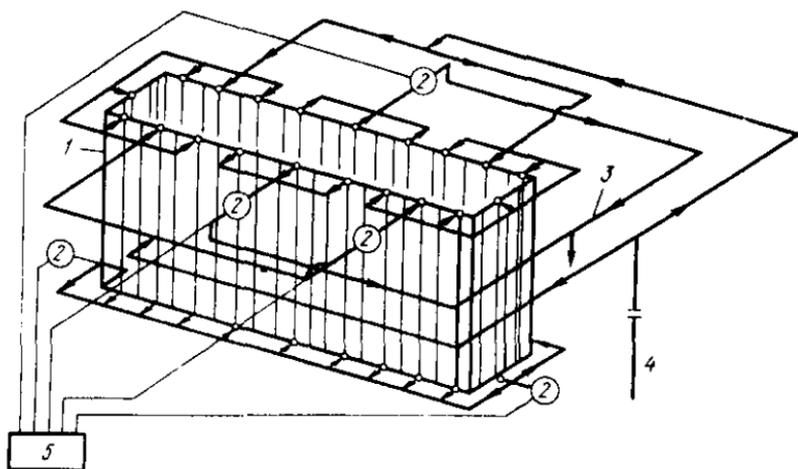
Рис. 11. Петлеобразная схема охлаждения кристаллизатора:
