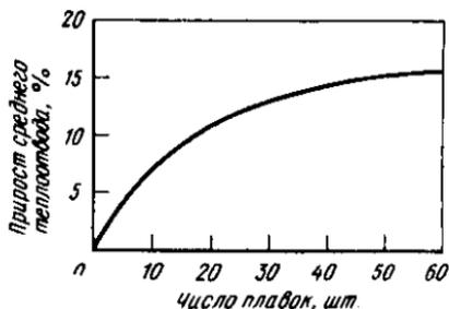
Рис. 10. Изменение среднего теплоотвода в кристаллизаторе
