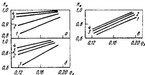
Рис. 33. Зависимость коэффициента использования воды от степени экранирования при расстояниях от форсунки до поверхности, м: а — 0,3; б — 0,4; в — 0,5 и давлении перед форсункой, мПа: 1 — 0,1; 2 — 0,2; 3 — 0,3; 4 — 0,4
