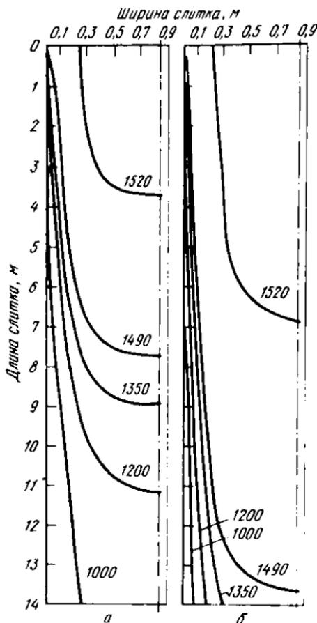
Расчетами установлена конкретная зависимость толщины корочки от скорости разливки. Так, в момент выхода из кристаллизатора толщина затвердевающей корочки слитка по середине широкой грани для скоростей разливки 0,4 и 0,7 м/мин соответственно равна 37 и 22 мм, а для середины узкой грани — 50 и 35 мм.
