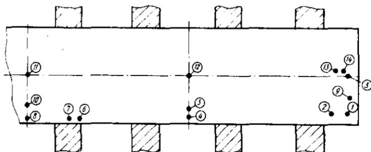
Рис. 23. Схема расположения термопар в сечении слитка, цифры – номера термопар
