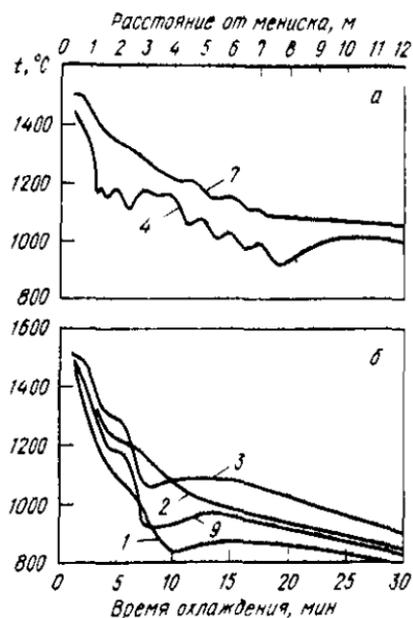
Рис. 25. Изменение температур подповерхностных точек слитка на широкой грани (а) и у ребра слитка (б)
