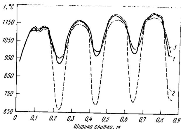
Рис. 41. Распределение температуры поверхности по ширине слитка при уровне от мениска, м: 1 - 1,72; 2 - 2,02; 3 - 2,52
