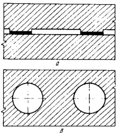
таллизатора либо собираются в особом корпусе, либо соединяются между собой с помощью специальных стяжек и болтов. Кристаллизаторы этого типа находят широкое применение для сортовых отливок.
