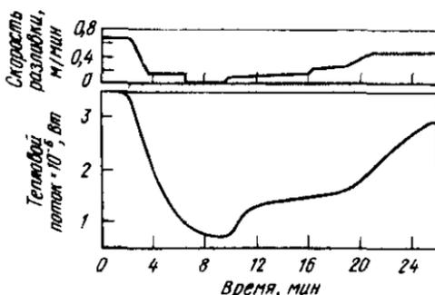
Рис. 13. Переходные процессы в кристаллизаторе
