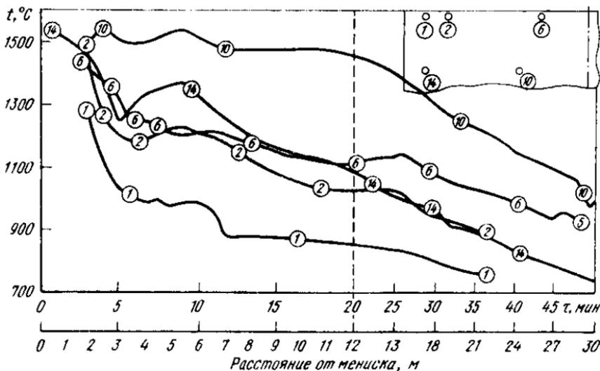
Рис. 28. Изменение температур в сечении криволинейного слитка (цифры — номера термопар)
