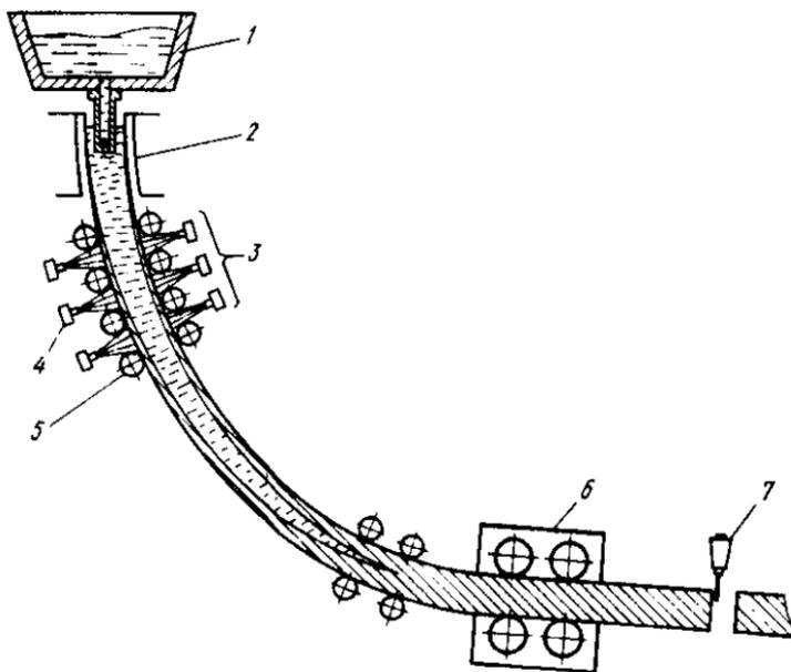
Рис. 1. Схема криволинейной МНЛЗ
