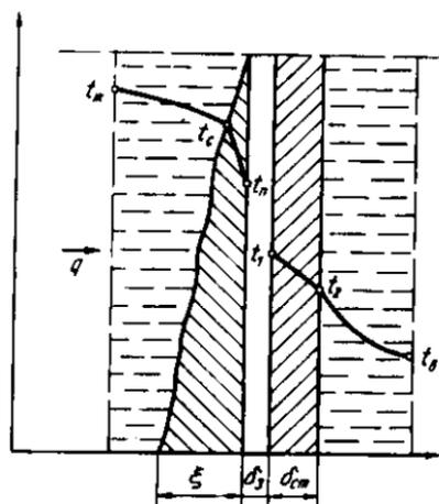
Рис. 6. Схема теплопередачи в кристаллизаторе
