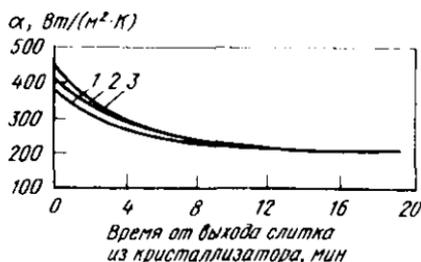
Рис. 32. Зависимость коэффициента теплоотдачи от времени сталей: 1 — низколегированных; 2 — углеродистых; 3 — для производства автолиста
