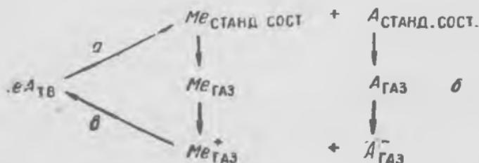
а) один моль кристаллической соли превращается в элементы в их стандартном состоянии; при этом поглощается количество энергии, равное термохимической теплоте образования соли;
