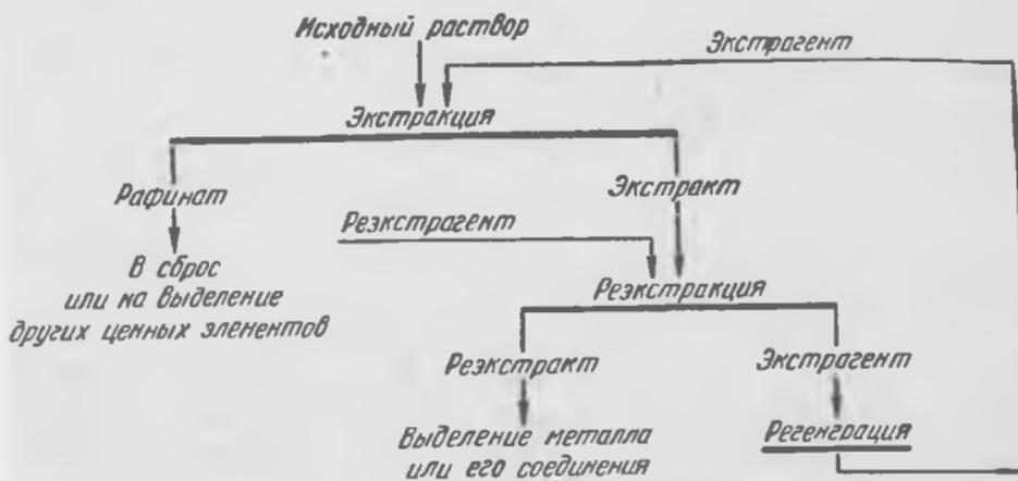
Рис. 95. Принципиальная схема экстракционного извлечения металла из раствора
