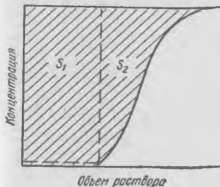
Рис. 72 Выходная кривая сорбции
