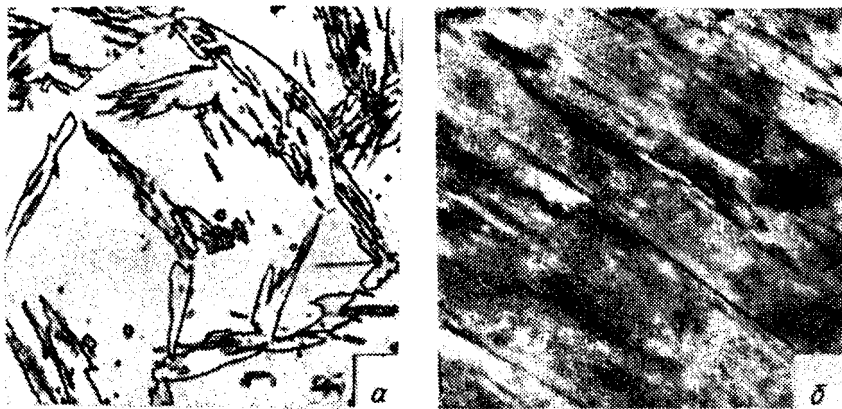
Рис. 205. Структура речного (пакетного) мартенсита (железо-никелевые сплавы): а — световая микроскопия, X 400; б — просвечивающая электронная микроскопия. X16 000
