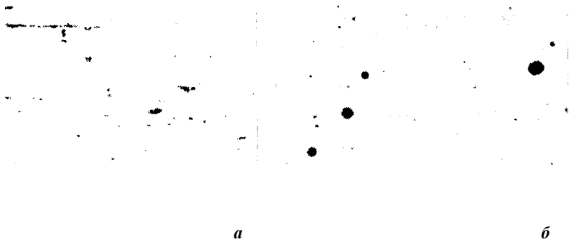
Рис. 154. Неметаллические включения: а — сульфиды (пластинчатые); б — оксиды (хрупкие)
