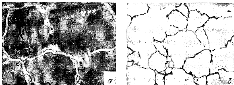
Рис. 144. Структура эвтектоидной стали. Перлит + сетка цементита, Х450: а — травление 4 %-ной азотной кислотой; б — травление пикратом натрия
