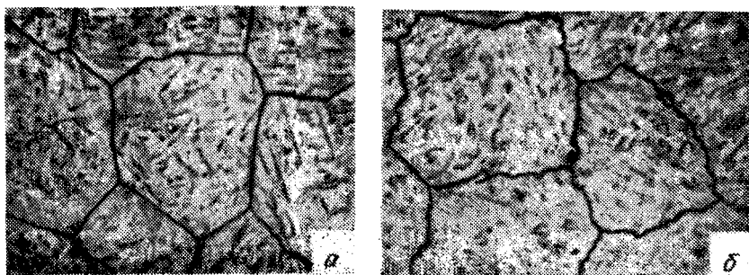
Рис. 177. Сохранение наследственной зернистости в закаленной стали, X150:
