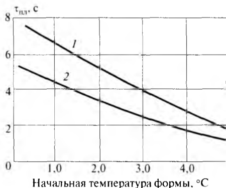
Рис. 12.10. Зависимость времени расплавления корки затвердевшего титана от начальной температуры формы t_{2н} при \omega = 1 м/с и \Delta t_{пер} = 100 °C
