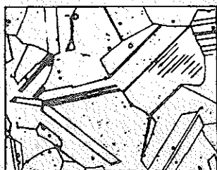
Рис. 30. Двойники в сплаве меди.
