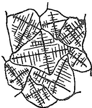
Рис. 24. Схема образования зерен из дендритов при кристаллизации металла (по Д. К. Чернову).
