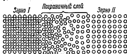
Рис. 16. Схема размещения атомов внутри и по границам зерен.
