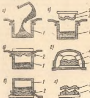
115-расм. Қобиқ қолип тайёрлаш схемаси.
