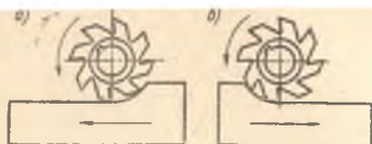
241- расм. Суриш йўналишига тескари ва суриш йўналиши бўйлаб фрезалаш.
