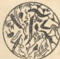
78- расм. Феррит-перлитли чўянинг микроструктураси (× 150).
