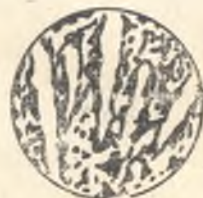
74- расм. Эвтектикадан кейинги (таркибида 5% С бўлган чўяннинг) микроструктураси ( \times 200 ).
