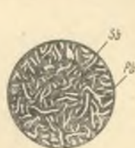
58-расм. Pb—Sb системаси эвтектикавий қотишмаси микроструктурасининг схемаси.
