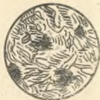
82-рasm. Асоси перлит бўлган болғаланувчан чўянинг микро-структураси (× 150).
