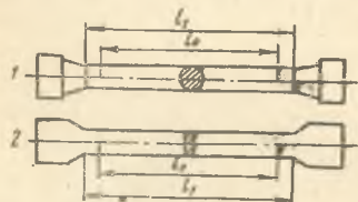
38- расм. Металлларни статикавий синаш учун ишлатиладиган намуналар: 1 — доиравий кесимли; 2 — ясси.
