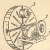
222-рasm. Заготовканинг планшайбага бурчаклик воситасида маҳкамланиши.
