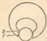
185- расм. Вали чекли калибр-скоба билан контроль қилиш схемаси: 1 — ўтувчи қисми; 2 — ўтмайдиған қисми.
