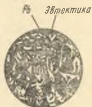
59-расм. Pb—Sb системасининг эвтектикадан олдинги қотишмаси микроструктурасининг схемаси
