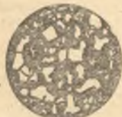
97- расм. Баббитнинг микро- структураси
