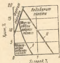
91-расм. Хромли пўлатнинг структура жиҳатидан бўлиниш диаграммаси.
