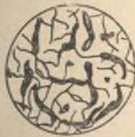
77- расм. Ферритли чўянинг микроструктураси (× 150).
