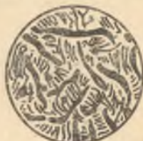
79- расм. Перлитли чўянинг микроструктураси (× 150).
