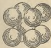
29-расм. Ҳажми марказлашган кубнинг элементар катакчаси.
