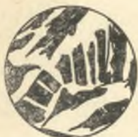
86-рasm. Эвтектоиддан олдинги пўлатнинг йирик донали структураси.
