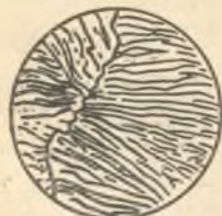
68- расм. Перлитнинг микроструктураси (x1200)
