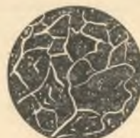
70- расм. Таркибида 1,2 % углерод бўлган пўлатнинг микроструктураси (x600).
