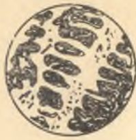
73- расм. Эвтектикадан олдинги (таркибида 3% С бўлган) чўяннинг микроструктураси ( \times 200 ).
