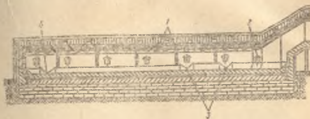
25- расм. Штейн суюқлантириб олиш учун ишлатиладиган акс эттирувчи печнинг схемаси
