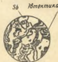
60-расм. Pb—Sb системасининг эвтектикадан кейинги қотишмаси микроструктурасининг схемаси.
