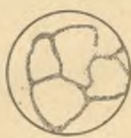
54-рasm. Никель — қалай қотишмасининг микро-радиоавтографияси.
