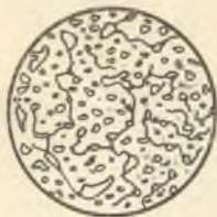
87-рasm. Донадор перлитнинг микроструктураси ( \times 500 ).
