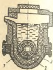
119-расм. Пулат ўзакли индукцион печнинг схемаси.
