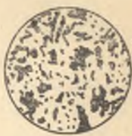
72- расм. Эвтектикавий чўяннинг (ледебуритнинг) микроструктураси ( \times 200 )
