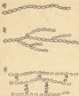
279-расм. Полимерларнинг структураси (тузилиши).
