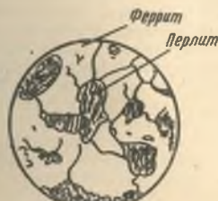
69- расм. Таркибида 0,3 % С бўлган пўлатнинг микроструктураси (x600).
