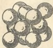
31-расм. Ёқлари марказлашган кубнинг элементар катакчаси.
