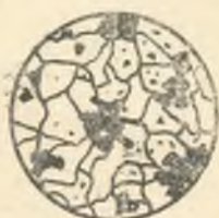
81-рasm. Асоси феррит бўлган болғаланувчан чўянинг микро-структураси (× 150).
