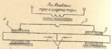
171- расм. Учма-уч пайвандлаш схемаси.
