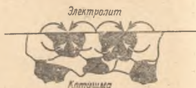
99- расм. Электрохимиявий коррозия схемаси
