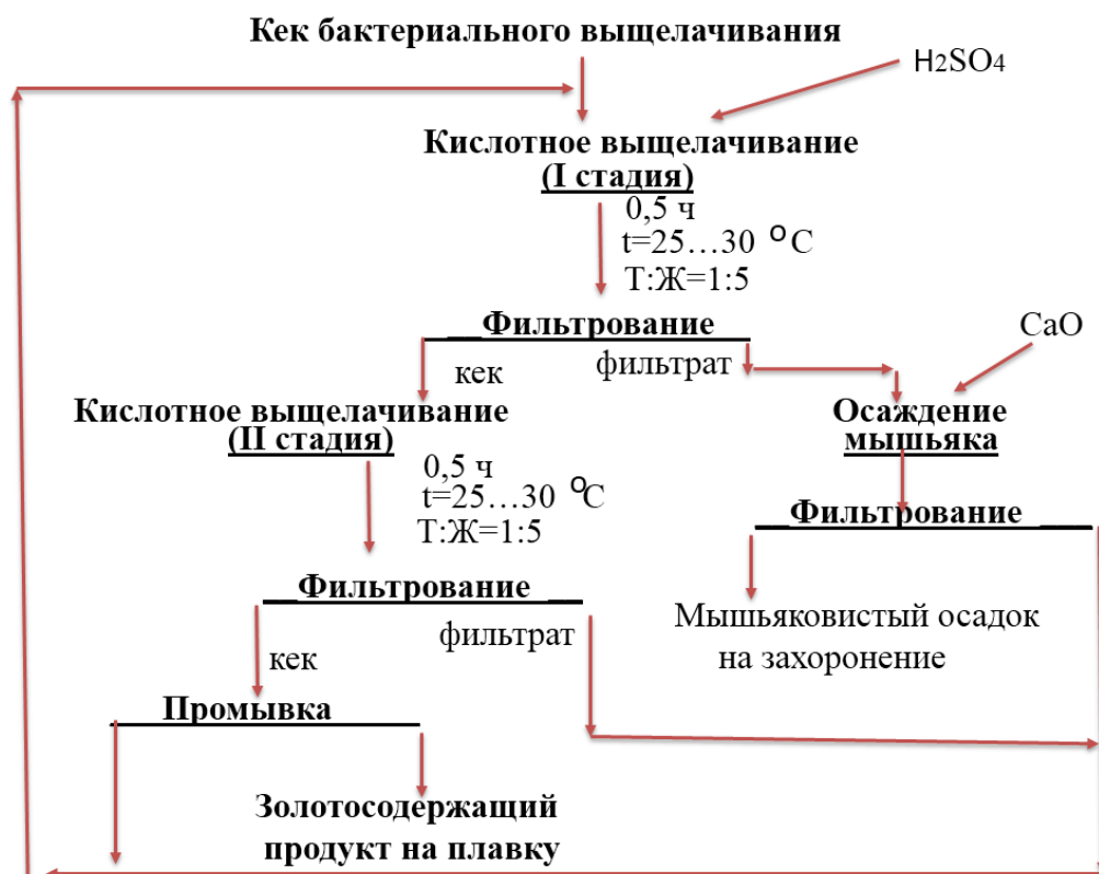
Рис. 6.10. Схема кислотного выщелачивания кек бактериального выщелачивания и осаждения мышьяка.
