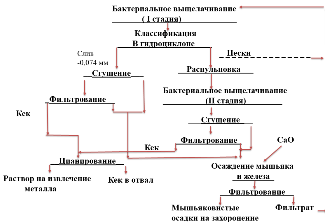
Рис. 6.4. Схема двустадийного выщелачивания золотомышьякового концентрата.
