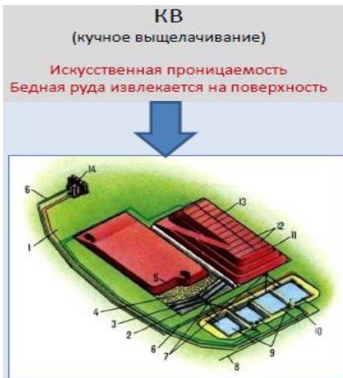
Рис. 7.1. Схематическое изображение площадки и кучи для выщелачивания благородных металлов (вид сверху).
