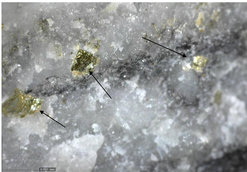
Рис. 6.4.3. Тонкие вкрапления пирита в руде из Марджанбулака.
