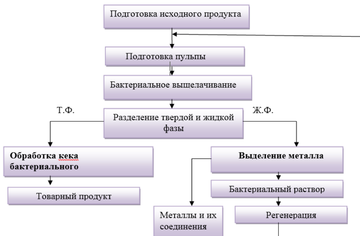
Рис. 6.1. Основные циклы процесса бактериального выщелачивания.
