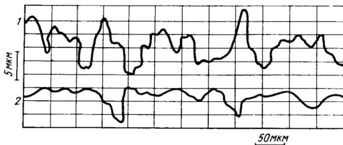
Рис. 40. Профилоскопические диаграммы поверхностей стали 08X18H10T после анодного растворения в 2,06-м. растворе NaCl при  $\varphi_a = 3$  В (н.х.э.) в потенциостатическом (1) и импульсно-потенциостатическом (2) режимах. Частота импульсов  $\nu = 5$  Гц, скважность  $S = 2$ ,  $t = 20^\circ\text{C}$ ,  $\nu_3 = 3,4$  м/с
