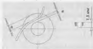
10.5-rasm. Arra bilan qobirg'a orasidagi o'lchamlar.
