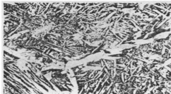
5.3 –rasm. Evtektoidgacha bo'lgan po'lat. Vidmanshtettov strukturası. X500
