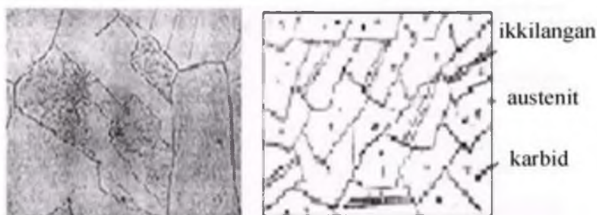
4.6 - rasm. Austenit sinfidagi po'latlarning mikrostrukturasi
