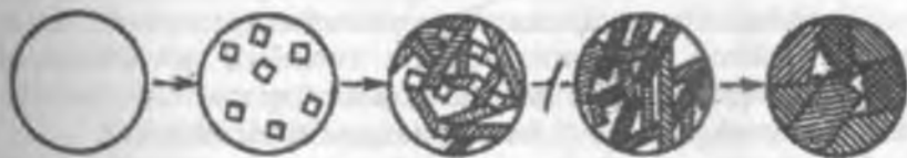
4.5-rasm . Katalizatorlar yordamida shishani sitallarga bo'linishi
