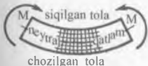
6.7 – rasm. Neytral qatlamni aniqlashga oid sxema
