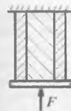
2.14 - rasm. Har xil materialdan tashkil topgan statik noaniq masala
