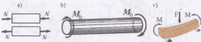
9- rasm. Ichki kuch faktorlari: a) bo'ylama kuch; b) burovchi moment; v) eguvchi moment
