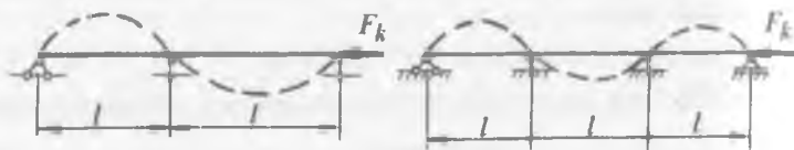
10.4 – rasm. sterjenni ikki va uch yarim to'liqlinli (sinusida) noustuvor holatalari
