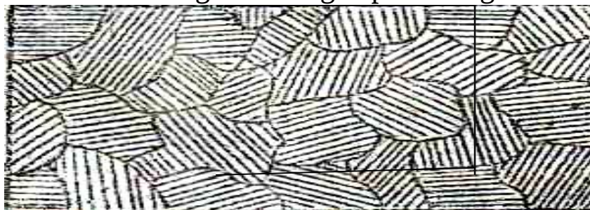
12-Rasm. Evtektoidli poʻlatning mikrostrukturasi
