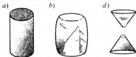
3.9-chizma. Cho'yan namunaning siqilish jarayoni
