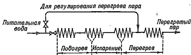
Рис. III-15. Принципиальная схема прямого котла.
